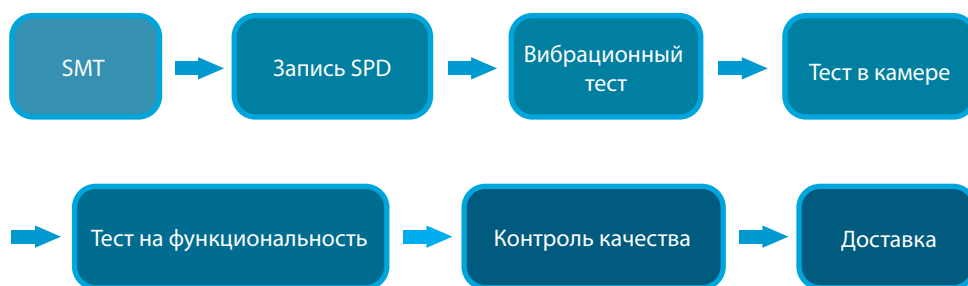
Рисунок 2: Процедура температурного тестирования DRAM
