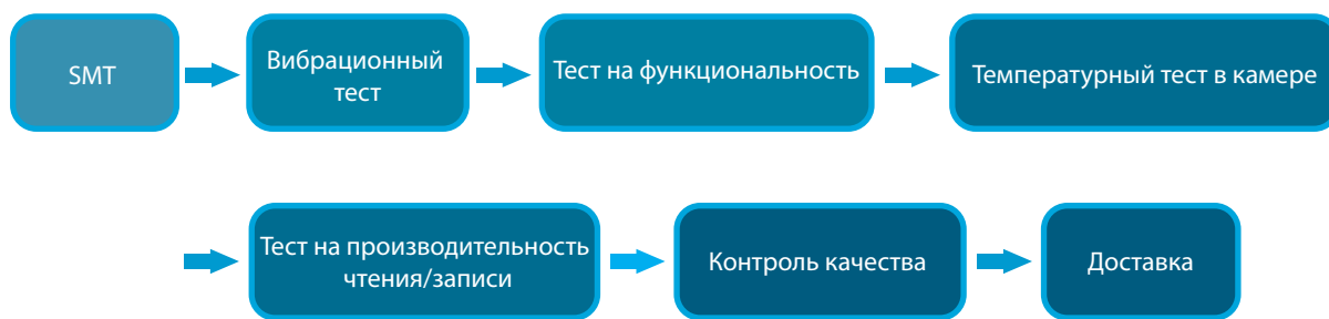
Рисунок 1: Процедура температурного тестирования SSD
